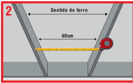
A distância mínima em relação ao telhado deve ser de 1m e o espaçamento máximo da estrutura de fixação deve ser de 40cm.
