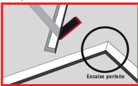
Para a instalação do Acabamento Convencional, nos cantos faça um corte diagonal (meio esquadro, 45°) para obter o encaixe.
