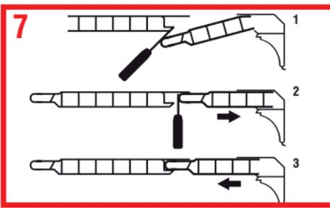
Encaixe o lado cortado nas duas extremidades dentro do acabamento. Mesmo que fique sobreposto ao perfil do forro de PVC anterior. Com a ajuda de uma espátula empurre o forro de PVC sobreposto ao perfil do forro de PVC em toda sua extensão (1). Depois empurre o encaixe macho contra o encaixe fêmea do perfil do forro de PVC anterior (3).
