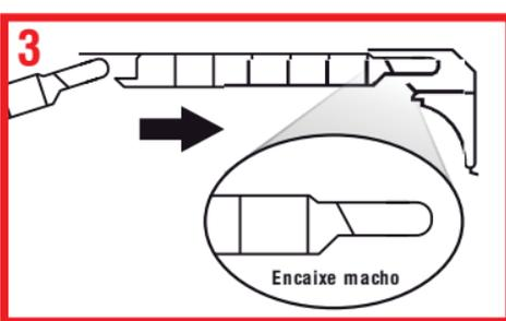
Com os forros de PVC ajustados, encaixe-os no acabamento. O encaixe macho deve ficar voltado para o fundo do acabamento, dando sequência na instalação sempre encaixando o encaixe macho no encaixe fêmea. A identificação PLASBIL NBR 14285 deve estar voltada para a cobertura. Siga a sequência de encaixe.
