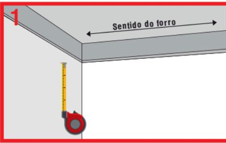
Defina o sentido em que o forro de PVC será instalado. Marque a altura em relação ao solo em que o forro de PVC será instalado. A marcação deve ser feita em todos os cantos das paredes e, depois, marque em todas as paredes no mesmo nível.
