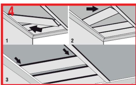
Para encaixar o forro de PVC com maior facilidade no acabamento, siga a sequência de encaixe acima.
