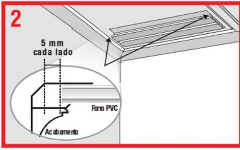
Deixe uma folga de 5 mm entre o forro de PVC e a extremidade do acabamento escolhido, de ambos os lados, para evitar ondulações devido a dilatação do forro de PVC.
