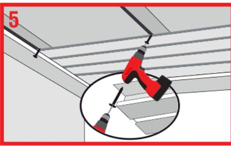
Após encaixar o forro de PVC, fixe-o em todas as travessas da estrutura de sustentação. Dê sequência à instalação até o último perfil.
