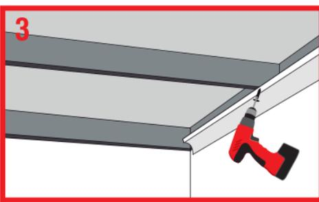
Ajuste o comprimento do Acabamento Premium ou Nobre em relação a parede e fixe o mesmo em toda sua extensão diretamente na parede ou na estrutura de fixação.
