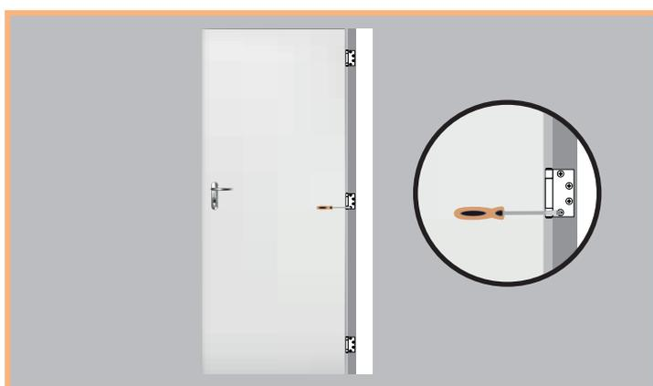
Parafuse as dobradiças já acopladas na porta no marco, usando uma chave de fenda, philips ou parafusadeira.
