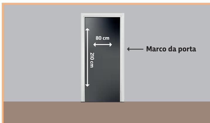
O primeiro passo para a instalação da Porta de Giro de PVC da Plasbil é verificar o marco da porta, o mesmo deve conter o vão de 80 cm de largura por 210 cm de altura.
