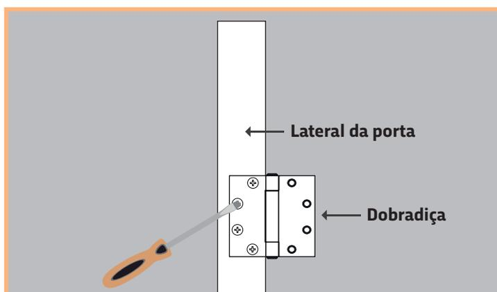
Com o vão na medida correta, inicie a fixação das dobradiças. Nas extremidades da lateral da porta, deixe um espaço livre de aproximadamente 20 cm para fixação das dobradiças, a terceira dobradiça deve instalada ao centro da mesma lateral.
