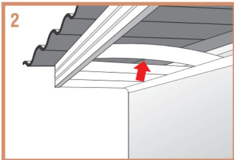
2 Encaixe o forro de PVC flexionando levemente o perfil do forro de PVC para cima e após empurre o mesmo do encontro ao encaixe do acabamento e da soleira espelho de PVC. Fixe o forro de PVC na estrutura de sustentação.
