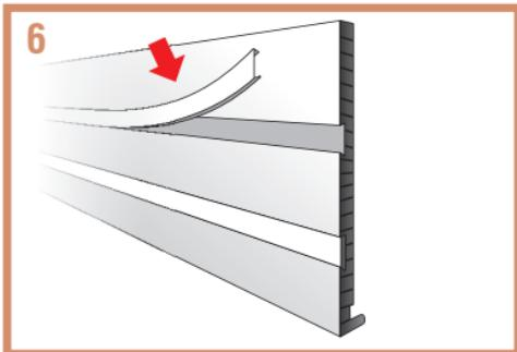
6 Após fixar a soleira espelho de PVC em toda sua extensão, recoloca as canaletas, ocultando assim os pregos ou parafusos. Curve levemente o filete e, com a ponta dos dedos, vá fixando junto à canaleta. Também pode ser utilizado martelo de borracha.
