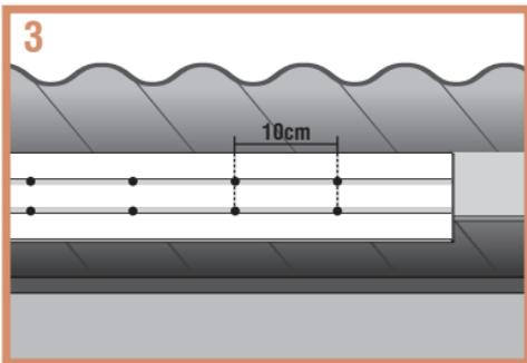
3 Ajuste o comprimento da soleira espelho em relação a aba. Fixe a soleira espelho de PVC no filete de madeira preso no barrote. A distância máxima para cada fixador deve ser de 10 cm contemplando as duas canaletas.
