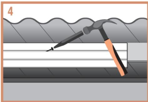
4 Se optar pela fixação com pregos utilize a ferramenta punção empurrando o prego até o fim da canaleta.
