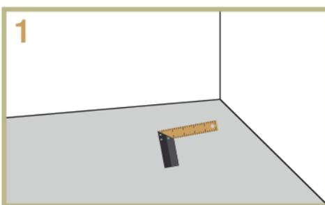
1. Verifique se o contrapiso está limpo, seco, nivelado e firme. Deixe o piso vinílico no local por 48 horas antes da instalação para aclimatá-lo. Retire rodapés e outros obstáculos nas bordas das paredes.
