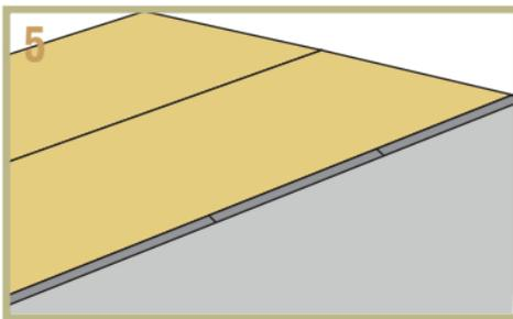
5. Inicie a segunda fileira com um pedaço cortado da última peça da fileira anterior para criar um padrão de junta desencontrada. Use um martelo de borracha e um bloco de proteção para garantir o encaixe.
