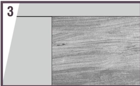
Seguidas as instruções do adesivo, assim que o adesivo estiver seco, comece a colocar os pisos a partir do ponto central da sala e, gradualmente, em toda a área. Use o martelo de borracha para bater levemente no piso para garantir que ele esteja firme ao chão. Repita até que a instalação seja concluída.
