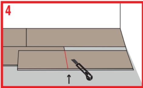
A última peça encostada na parede: para encaixar o piso de borda que precisa ser cortado, coloque-o exatamente sobre o último piso completo; coloque outro piso completo contra a parede e marque a linha de corte onde o piso se sobrepõe. Corte o piso na posição.
