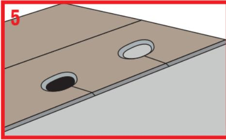
Tubo ou pilar irregular: basta fazer um modelo de papelão como guia e usá-lo para desenhar um contorno no piso. Corte no formato e verifique se encaixa.
