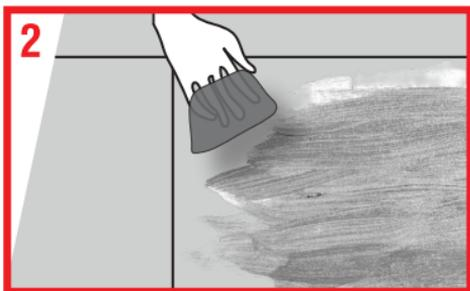
Meça a sala antes da instalação. Divida-a em 4 seções desenhando 2 linhas perpendiculares no chão. Aplique o adesivo quando estiver pronto para instalar o piso, começando por qualquer seção. Use a espátula adequada em um ângulo de 80 graus para espalhar o adesivo de maneira uniforme.
