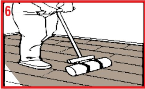
Qualquer imperfeição de instalação deve ser corrigida dentro de uma hora após a instalação do piso. Depois de instalados os pisos, use um rolo de piso de 70 kg para garantir que os pisos estejam firmemente aderidos ao contrapiso. A laminação deve ocorrer durante o tempo de trabalho do adesivo.
