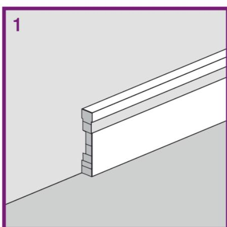
1 Posicione o rodapé de PVC Plasbil no local onde será instalado e marque a direção do corte.
